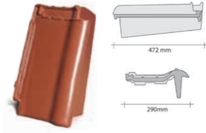
taška okrajová pravá - krycí délka cca: 36,5–40,3 cm - krycí šířka cca: 24,5 cm - hmotnost 1 ks cca: 5,3 kg Spotřeba cca 2,7–2,4 ks/bm délky okrajové hrany.
