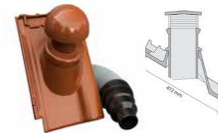
komplet pro odvětrání kanalizace: prostupová taška, nástavec, flexi hadice - díky rotační trubce se dokonale přizpůsobí sklonu střechy - optimální sklon střechy - hmotnost tašky: 4,1 kg - hmotnost hadice cca: 3,0 kg - celková hmotnost 1 ks cca: 7,1 kg - vnitřní průměr otvoru Ø cca: 100 mm
