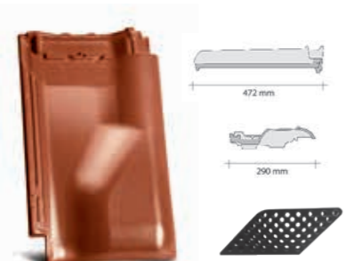
větrací taška - větrací průměr cca: 23 cm 2 - hmotnost 1 ks cca: 4,5 kg Obvykle se větrací tašky pokládají do 2 řady pod hřebenem. Součástí tašky je mřížka do otvoru proti škůdcům.
