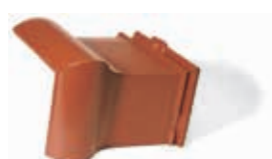
pultová taška s úhlem 70° nebo 90°. Krycí délka uvedena v technických kartách. - hmotnost 1 ks cca: 3,5 kg / celková délka cca: 210 mm
