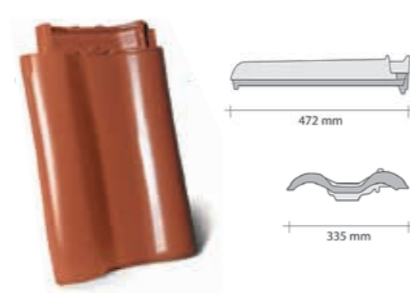
taška s dvojitou návalkou - krycí délka cca: 36,5–40,3 cm - krycí šířka cca: 33,5 cm - hmotnost 1 ks cca: 4,7 kg - používá se jako estetické zakončení levého okraje plochy střechy, namísto základních tašek u kterých by byl vidět zámek. Např. v místě kde střešní plocha navazuje na vyšší stěnu štitu vedlejšího domu.
