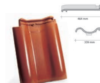
taška s dvojitou návalkou - krycí délka cca: 38,3-40,3 cm - krycí šířka cca: 33,9 cm - hmotnost 1 ks cca: 3,5 kg - používá se jako estetické zakončení levého okraje plochy střechy, namísto základních tašek u kterých by byl vidět zámek. Např. v místě kde střešní plocha navazuje na vyšší stěnu štitu vedlejšího domu
