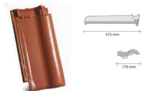
taška poloviční - hmotnost 1 ks cca: 2,5 kg - střední krycí šířka cca: 12,5 cm Poloviční taška není vhodná do úžlabí! Taška v zámku nenavazuje na základní tašku! Zámek má jiný tvar. Používá se jen jako jedna řada tašek od okapu do hřebene, pro dosažení rozšíření krycí šíře střešní krytiny o krycí šířku poloviční tašky, což je cca 125 mm.
