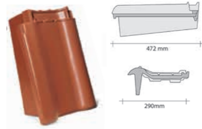
taška okrajová levá - krycí délka cca: 36,5–40,3 cm - krycí šířka cca: 33,5 cm - hmotnost 1 ks cca: 5,7 kg Spotřeba cca 2,7–2,4 ks/bm délky okrajové hrany.
