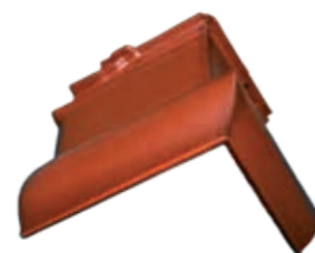
taška pultová hmotnost cca 3,3 kg dostupná pro úhel 70° nebo 90° Při použití pultové tašky je třeba přizpůsobit laťování na cca 180 mm. Tašky pultové – základní, okrajové levé a pravé k dostání na objednávku.
